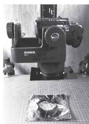
Рис. 13. Расположение фотоаппарата относительно глянцевой поверхности
