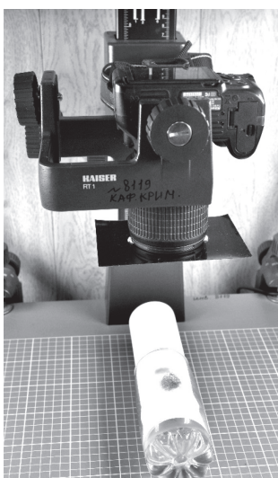
Рис. 9. Расположение фотоаппарата относительно стеклянного стакана
