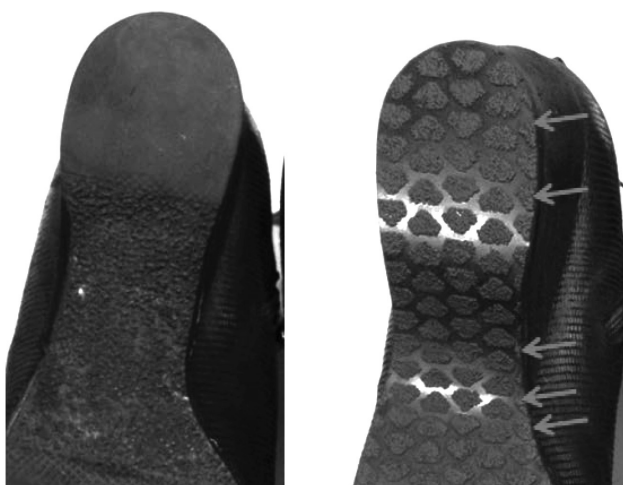
Илл. 5. Увеличенное изображение контуров ремонтной заготовки перед ее установкой и после
