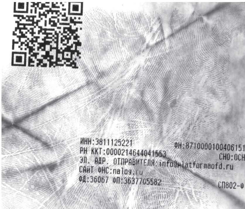
Илл. 1. Результат применения термического метода выявления следов пальцев рук
